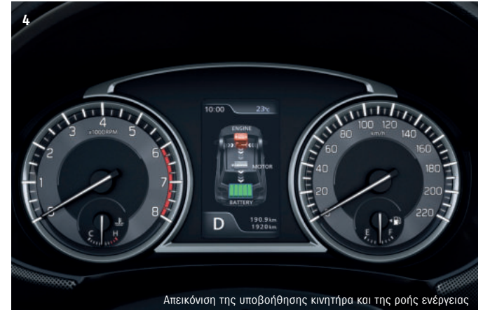
Απεικόνιση της υποβοήθησης κινητήρα και της ροής ενέργειας
