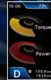
Ένδειξη ισχύος και ροπής του κινητήρα κατά την οδήγηση
