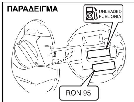
Εάν το όχημά σας δεν έχει εγκατασταθεί περιοριστή στο σωλήνα πληρώσεως καυσίμων και δεν είναι κολλημένη στο καπάκι πληρώσεως καυσίμου η ετικέτα “UNLEADED FUEL ONLY”, τότε μπορείτε να χρησιμοποιήσετε τη μολυβδόυχο ή αμόλυβδη βενζίνη με αριθμό οκτανίων (RON) 91 ή υψηλότερο. Σημειώστε ότι συνιστάται η χρήση αμόλυβδης βενζίνης.
