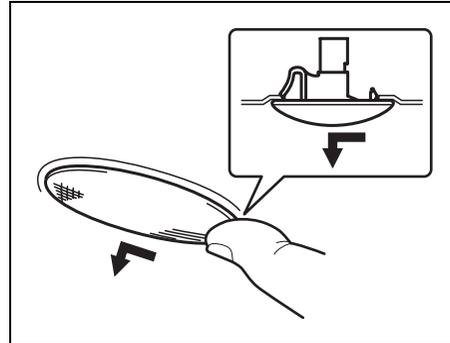
Δεδομένου ότι ο λαμπτήρας είναι ενσωματωμένου τύπου, η συναρμολόγηση του λαμπτήρα, πρέπει να αντικατασταθεί. Αφαιρέστε το περίβλημα φωτισμού ολίσθαινοντας το περίβλημα προς τα αριστερά με το δάχτυλό σας.
