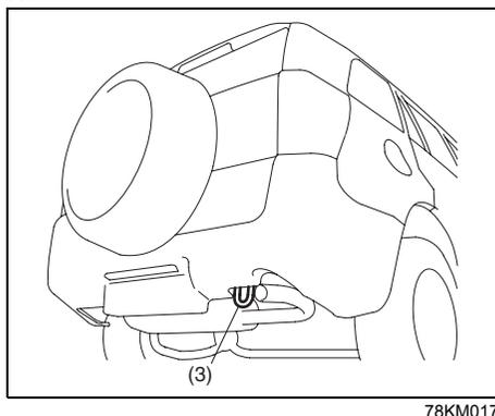
Άγκιστρα υπάρχουν στο μπροστινό και στο πίσω μέρος του αυτοκινήτου για χρήση σε έκτακτη περίπτωση.
