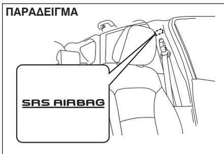
Οι αερόσακοι κουρτίνα βρίσκονται στις ράγες της οροφής του αυτοκινήτου. Οι ετικέτες "SRS AIRBAGS" βρίσκονται στις κολώνες για να υποδεικνύουν τις θέσεις των αερόσακων κουρτίνα.
