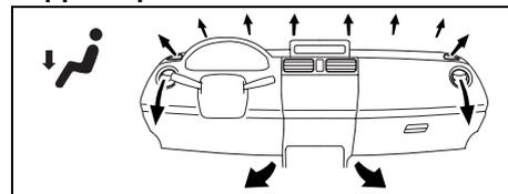
Αέρας στην επιθυμητή θερμοκρασία παρέχεται από τους αεραγωγούς δαπέδου, και τους πλαινούς, καθώς επίσης και από τους αεραγωγούς ξαθαμπώματος του παρμπρίζ αλλά και τους πλαινούς αεραγωγούς ξαθαμπώματος.
