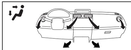
Αέρας στην επιθυμητή θερμοκρασία παρέχεται από τους αεραγωγούς του δαπέδου, και δροσερός αέρας από τον κεντρικό και τους πλαινούς αεραγωγούς. Όταν ο επιλογέας θερμοκρασίας βρίσκεται στη θέση τελείως ΚΡΥΟ ή τελείως ΖΕΣΤΟ, ο αέρας από τους αεραγωγούς δαπέδου,
