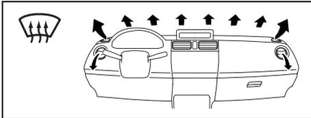
Κατά το γύρισμα του διακόπτη απόψυξης (6) εντός, ο ελεγχόμενος ως προς τη θερμοκρασία αέρας βγαίνει από τις εξόδους απόψυξης του ανεμοθώρακα, τις πλευρικές εξόδους απόψυξης και τις πλευρικές εξόδους. Επίσης, το σύστημα κλιματισμού θα ανάψει και ο τρόπος λειτουργίας "FRESH AIR" θα επιλεγεί αυτόματα. Όταν κάνει πολύ κρύο, το σύστημα κλιματισμού δεν ενεργοποιείται.
