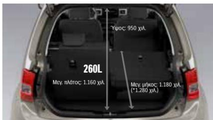
(\*) μέτρηση με συρμένο πίσω κάθισμα τοποθετημένο στην πιο μπροστινή θέση.
